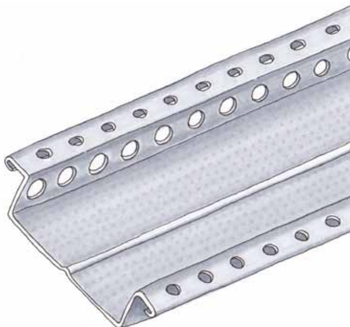
Tværsnit af ventileret stålprofil.
