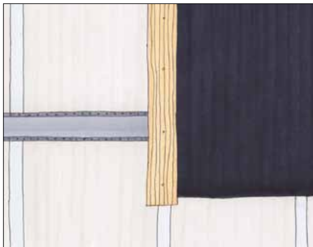
Eksempel på afslutning mod lysning med klemliste.
