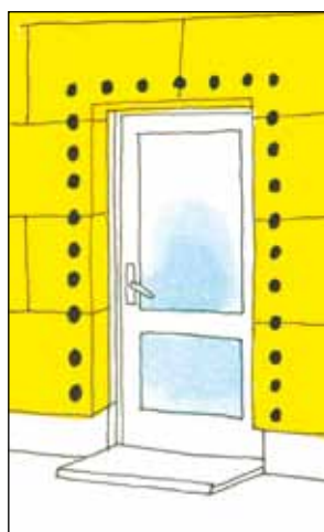
Eksempler på placering af ekstra dybler ved høj vindbelastning.
