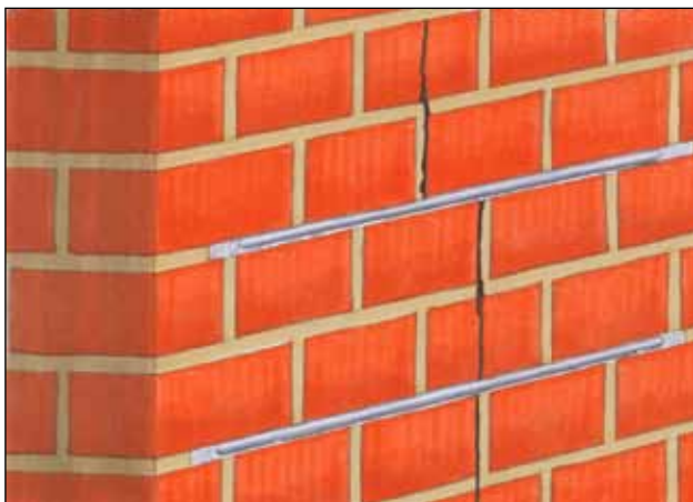
Sætningsrevner sikres med Skalflex Armeringssystem.
