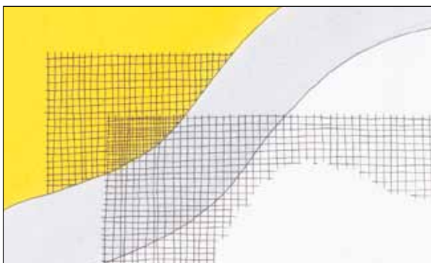
2. Efter ophærdning af første lag Grundpuds med net, trækkes et nyt 3-5 mm lag Grundpuds på facaden, hvori andet lag net indarbejdes. Dette net forskydes i forhold til første lag net.
